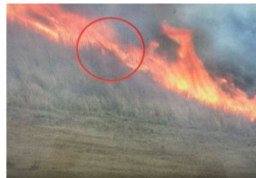
赤丸部分が延焼防止剤を散布した場所 噴霧された部分は焼けずに残りました
