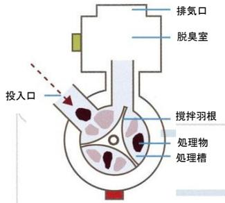
処理物を処理槽内に投入。投入口を密閉し外部からの空気供給を遮断
