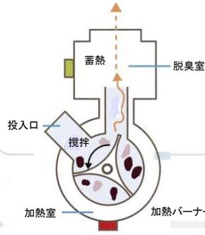
処理槽内を周囲からバーナーで加熱、処理物は酸素の極めて少ない状態で攪拌、減量。臭気は脱臭室に導かれ、脱臭され排出
