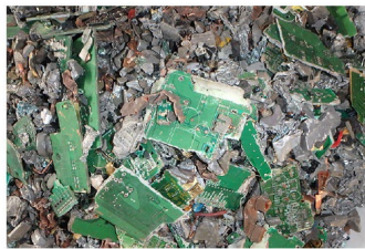
破砕された基板と金属の混合物
