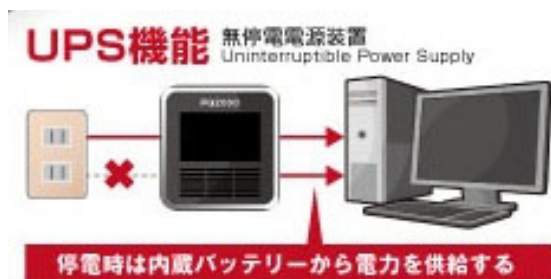
UPS(無停電電源装置)
